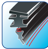
Torn blade Abgerissenes Wischgummi
