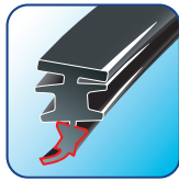
Bent blade Verbogenes Wischgummi
